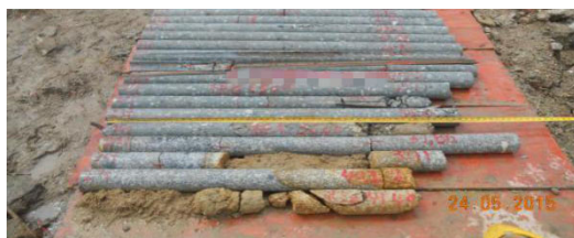
图 C.1.3-6 650#桩桩底沉渣 25cm，桩端持力层存在强风化夹层
