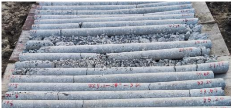
(b) 1-26#桩 3#孔芯样
