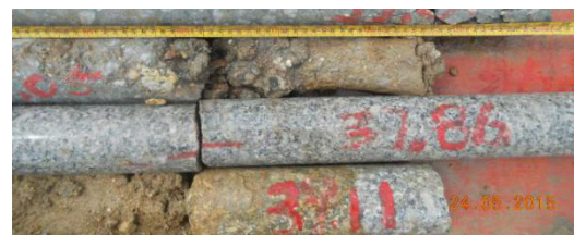
图 C.1.3-6 650#桩桩底沉渣 25cm，桩端持力层存在强风化夹层
