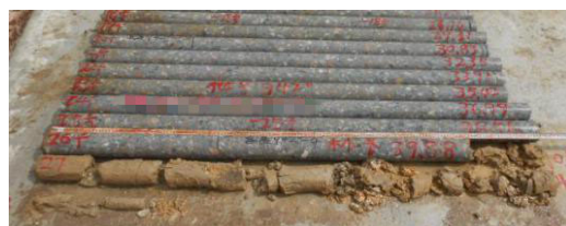
图 C.1.3-7 942#桩桩端强风化花岗岩
