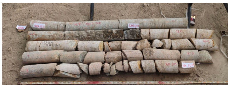
图 21 钻芯检测结果：底部混凝土与桩周接触不紧密
