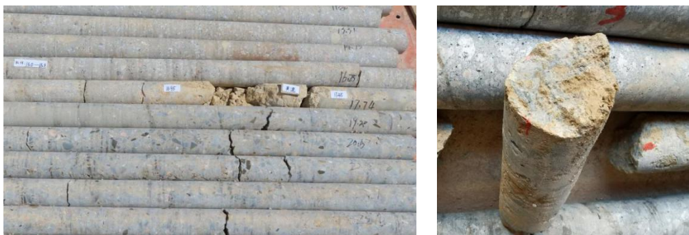
(a) 夹泥芯样外观特征 (b) 夹泥处芯样横断面
