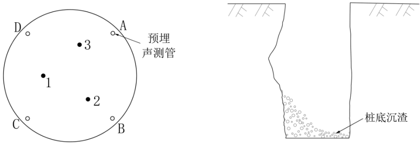
图 24 XW53#桩钻芯孔布置示意图 图 25 XW53#桩桩底沉渣分布示意图
