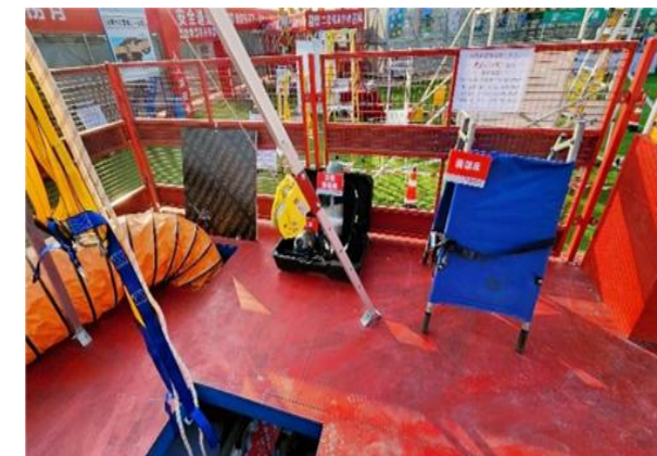
应急措施、安全应急物资(救援三脚架、担架床、急救箱)、对讲机、空气压缩瓶及面罩、防爆灯、全身式安全带、看守员
