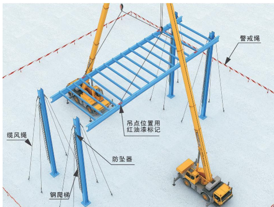
钢架吊装示意图
