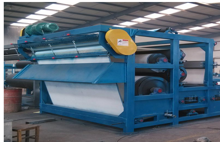
泥沙分离器（用于基坑桩基础阶段）
