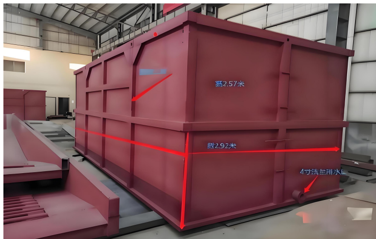
成品三级沉淀泥浆池
